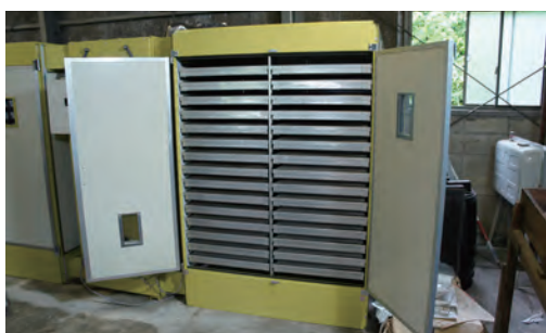
写真6-9 | 温風種子乾燥機(林木育種センター 業務資料より)
