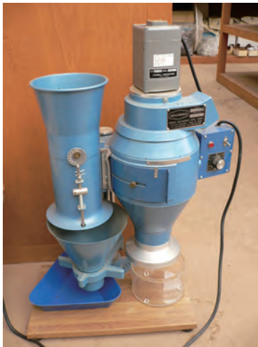
写真6-14 風選による種子精選装置(林木育種センター 業務資料より)
